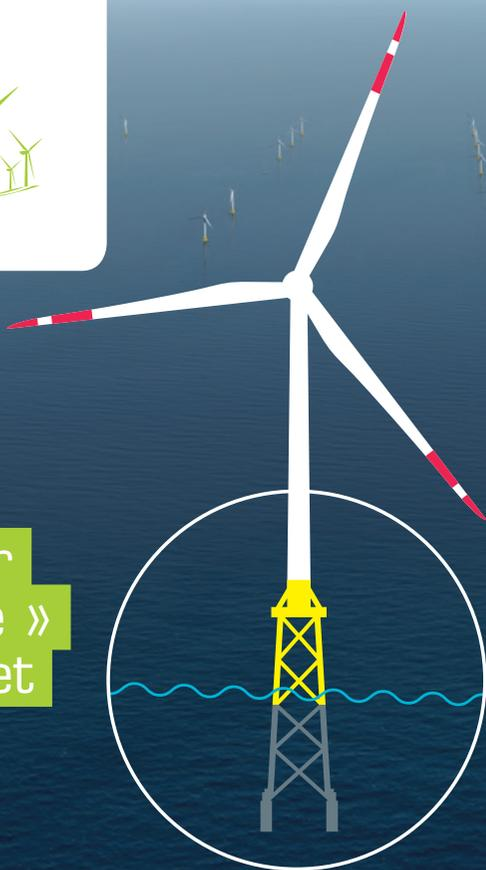
**Afin de protéger de la corrosion les structures métalliques immergées, une solution dite de « protection cathodique » doit être adoptée.**
